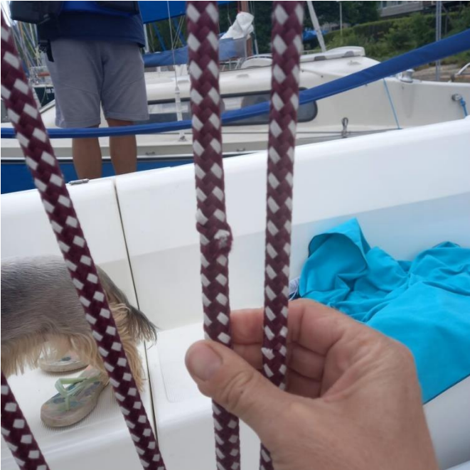
Příloha 1. poškození lan lodě týden po spuštění na vodu
